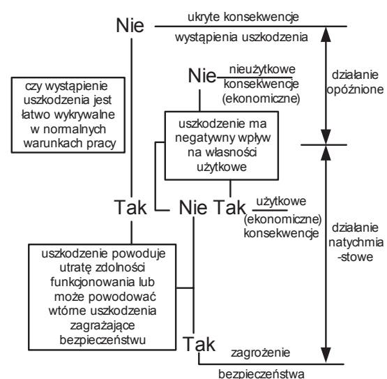
Rys. 1. Schemat niezawodnościowo zorientowanej analizy sytemu stosowanej w lotnictwie [8]
