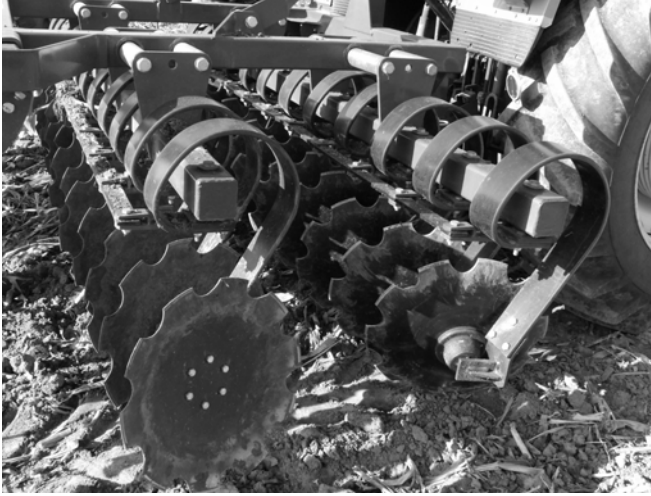
Fot. 1. Przykładowa wersja konstrukcji brony talerzowej kompaktowej Photo 1. An exemplary version of compact disc harrow construction
