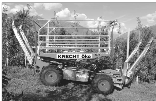
Rys. 2. Przykładowa platforma z napędem elektrycznym Fig. 2. An exemplary platform with an electric drive
