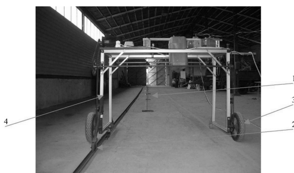
Rys. 2. Widok ogólny modułu rozpylaczy: 1 – sztuczna roślina, 2 – rolka prowadząca, 3 – koło biegowe 4 – nośnik rozpylaczy. Fig. 2. General view of atomisers' module: 1 – artificial plant, 2 – guide roll, 3 – road wheel, 4 – atomisers' carrier
