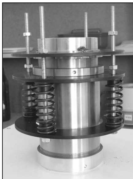
Rys. 1. Cylinder wywołujący naprężenia w masie ziarna Fig. 1. Cylinder generating stresses in the grain mass
