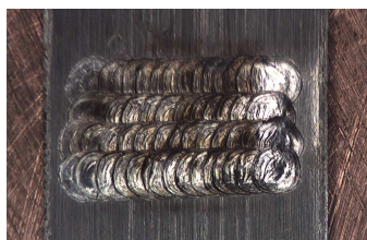
Rys. 9. Połączenie folii niklowej o grubości 0,15 mm z podłożem miedzianym
