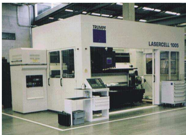
Rys. 1. Uniwersalne centrum obróbkowe Lasercell Trumpf TLC 1005 do cięcia, spawania i napawania laserowego z laserem gazowym CO 2 o mocy 3,8 kW
