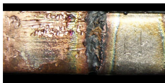
Rys. 8. Przykładowe połączenie miedzi ze specjalistycznym stopem oporowym: widok lica bezpośrednio po spawaniu
