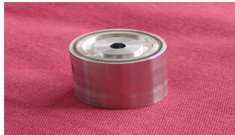
Rys. 5. Moduł sprzęgła magnetycznego (stal nierdzewna; przetop \leq 0,5 mm, laser CO 2 )
