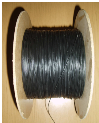
Rys. 8. Rowing w powłoce PCV: a) masa liniowa 1100 tex, b) masa liniowa 1700 tex
