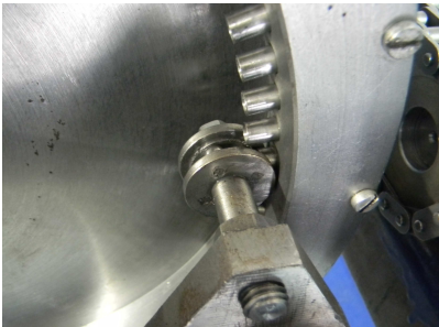
Rys. 7. Rozety ze sprzężeniem tocznym kul z czołami zazębionych z nimi kołków: a) rozeta wynosząca jeden kołek (4 kule), b) rozeta wynosząca dwa kołki (6 kul)
