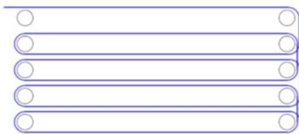
Rys. 3. Koncepcja nawijania rowingu wążkowego na stanowisku do bezspłotowego tworzenia płaskich struktur tekstylnych BEST
