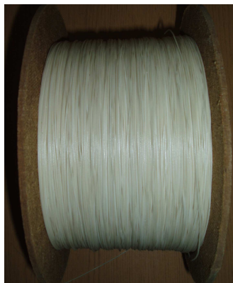
Rys. 8. Rowing w powłoce PCV: a) masa liniowa 1100 tex, b) masa liniowa 1700 tex
