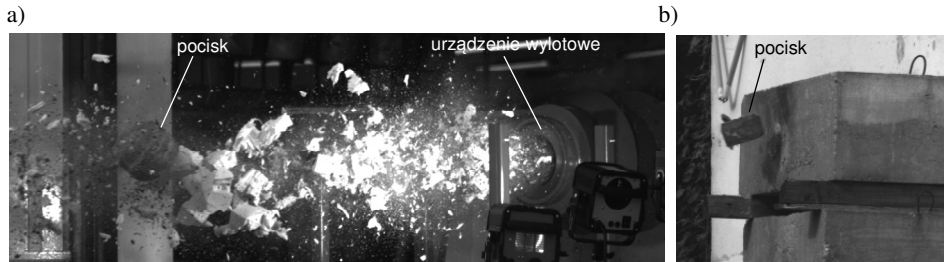
Rys. 15. Nieprawidłowe uwolnienie pocisku od sabota: a) zakłócenie trajektorii w urządzeniu wylotowym (czas naświetlania 40 \mu s, prędkość rejestracji 8000 fr/s), b) nieprawidłowa pozycja zderzenia z celem (czas naświetlania 60 \mu s, prędkość rejestracji 7500 fr/s)
