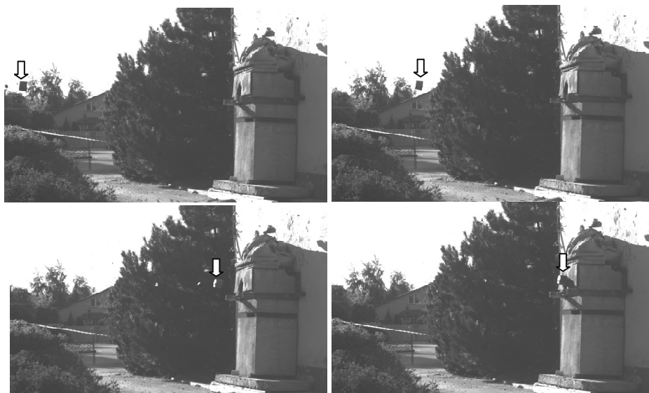
Rys. 22. Lot pocisku podkalibrowego w kierunku kulochwytu (czas naświetlania 90 \mu\text{s} , prędkość rejestracji 7500 \text{ fr/s} )
