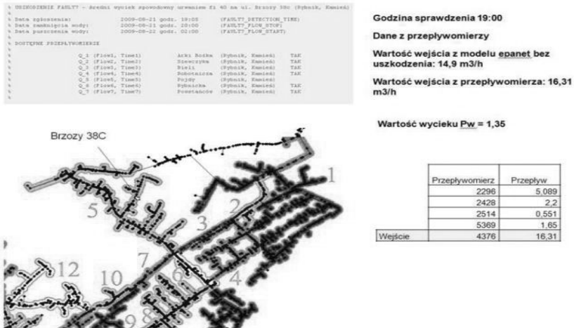
Rys. 3. Dane do lokalizacji wycieku na ulicy Brzozy 38C
