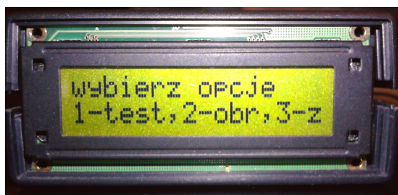
Rys. 3. Widok wyświetlacza LCD z menu wyboru Fig. 3. View of the liquid crystal display with the selection menu
