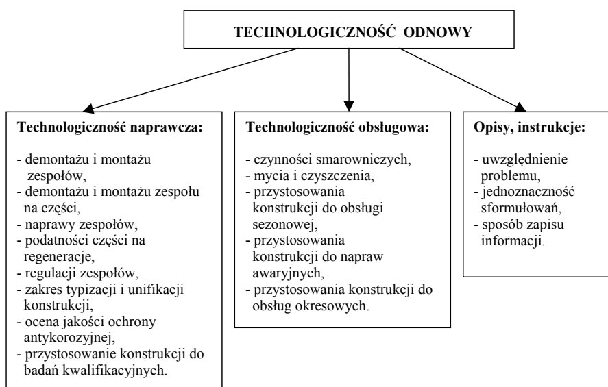
Rys. 1. Atrybuty technologiczności odnowy maszyn i urządzeń Fig. 1. Attributes of producibility of renovation of machines and equipment
