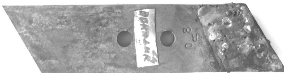
Rys. 3. Dłuto Kverneland z nałożoną napoiną Abradur 64 Fig. 3. Kverneland chisel with the applied Abradur 64 padding weld
