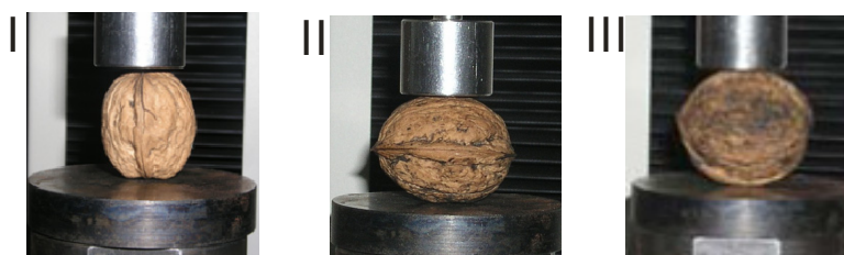
Rys.1. Sposób ułożenia orzecha w trakcie badań wytrzymałościowych Fig. 1. Positioning of the walnut during strength tests
