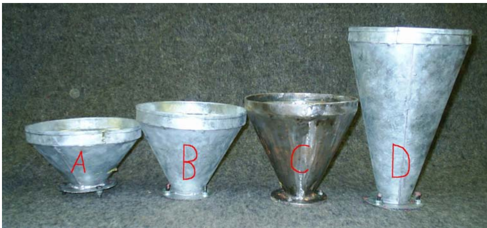
Rys. 2. Stożki dolnej części suszarki o różnych kątach rozwarcia: 70^\circ , 60^\circ , 50^\circ , 30^\circ Fig. 2. The bases of spouted drier from different coned angle: 70^\circ , 60^\circ , 50^\circ , 30^\circ
