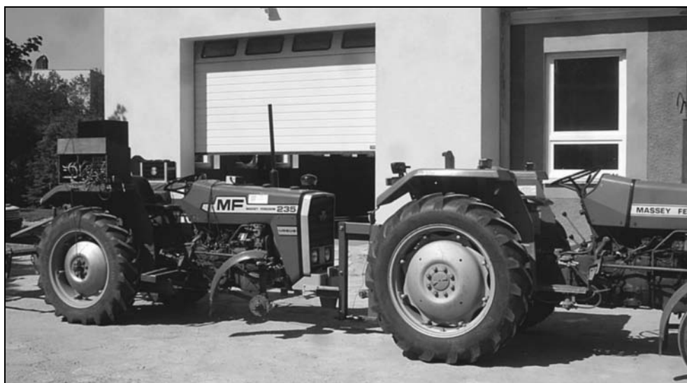
Rys. 2. Widok stanowiska przygotowanego do badań współczynnika oporu toczenia kół napędowych
