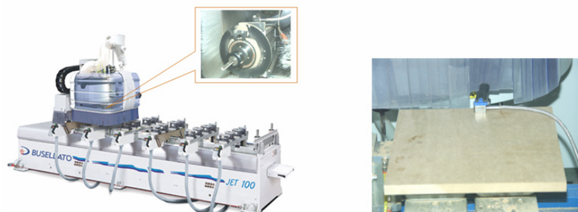
Rys. 2. Centrum obróbcze CNC firmy Buseclatto JET 100, przedmiot obrabiany oraz miejsce mocowania czujnika AE
