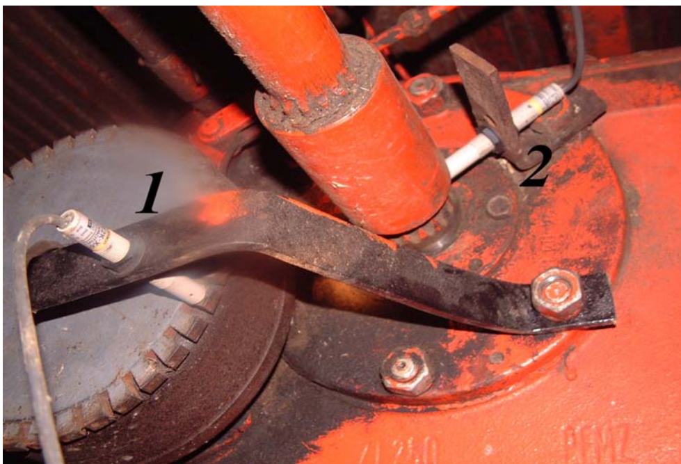
Rys. 1. Sposób montażu przetworników pomiarowych na korpusie zespołu przekładniowego. Oznaczenia: 1- Przetwornik pozycjonowania wału wyjściowego skrzyni biegów (wał wejściowy przekładni głównej), 2- Przetwornik pozycjonowania płośli napędowej
