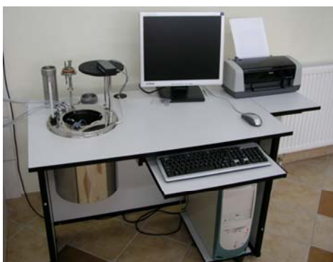
Rys. 1. Schemat kalorymetru KL-12Mn: 1 – bomba kalorymetryczna; 2 – pokrywa kalorymetru; 3 – czujnik temperatury; 4 – uchwyt pokrywy z umieszczonym napędem mieszadła mechanicznego; 5 – mieszadło mechaniczne; 6 – naczynie kalorymetryczne; 7 – płaszcz kalorymetru: a) ściana wewnętrzna, b) ściana zewnętrzna, c) wężownica, d) mieszadło ręczne; 8 – zespół sterujący kalorymetru; 9 – komputer; 10 – drukarka; 11 – monitor; 12 – stół kalorymetru; 13 – listwa zasilająca
