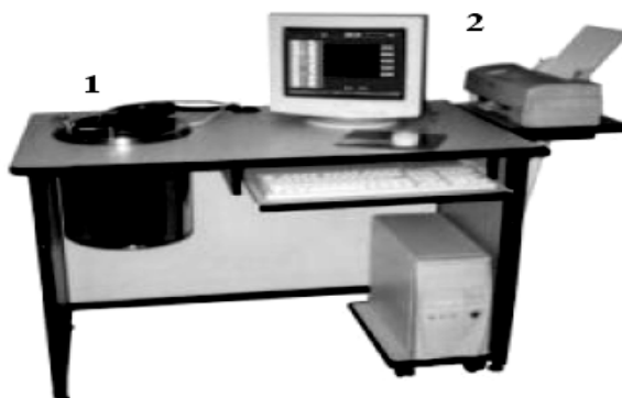
Rys. 1. Stanowisko pomiarowe do określania wartości opałowej: 1 – kalorymetr, 2 – zespół sterująco-pomiarowy
