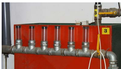
Rys. 1. Stanowisko badawcze do suszenia i termicznego odkażania nasion Fig. 1. Research station for drying and thermal disinfecting of seeds
