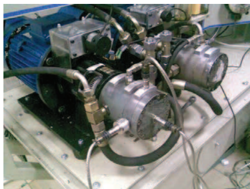
Rys. 5. Widok badanej pompy w na stanowisku badawczym
