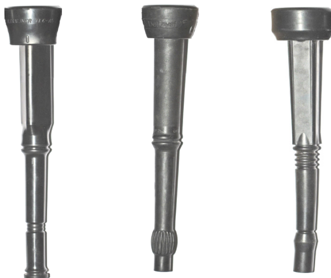
Rys. 1. Gumy strzykowe zastosowane w badaniach, kolejno od lewej: o profilu trójkątnym, owalnym i kwadratowym
