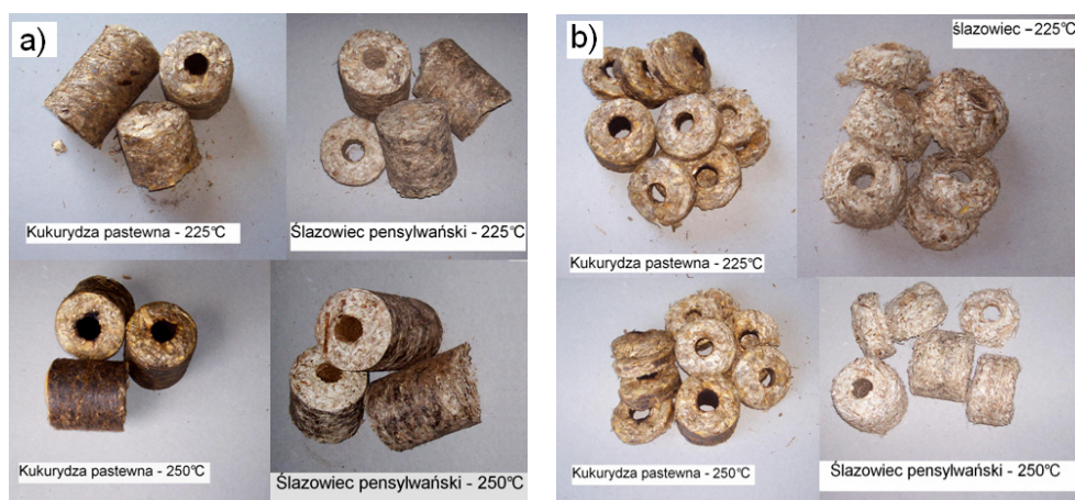
Rys. 4. Brykiety wytworzone w temperaturze 225 i 250°C: a) przed próbą trwałości, b) po próbie trwałości
