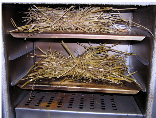
Rys. 1. Wiązki słomy w suszarce laboratoryjnej przed rozpoczęciem suszenia Fig. 1. Straw bundles in laboratory drier before commencement of drying
