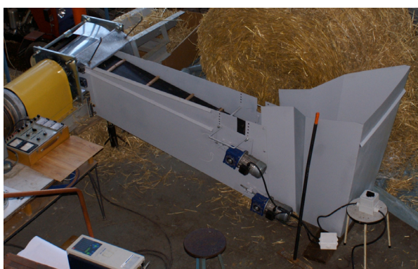
Rys. 3. Stanowisko laboratoryjne do badania procesu brykietowania słomy metodą zwijania Fig. 3. Laboratory setup for examining straw briquetting process using rolling method
