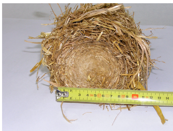
Rys. 2. Przekrój poprzeczny przez wykonany brykiet Fig. 2. Cross-section of a completed briquette
