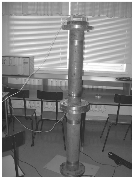
Rys. 1. Stanowisko badawcze do pomiaru mocy sygnału odbieranego Fig 1. Test stand for received signal power measurement
