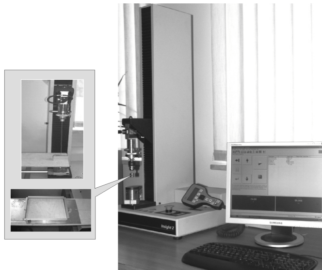
Rys. 1. Maszyna wytrzymałościowa MTS Insight II wraz z kasetą pomiarową Fig. 1. The MTS Insight II testing machine with measuring cassette
