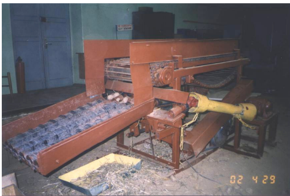
Rys. 1. Stanowisko badawcze z sekcją walcowego separatora czyszczącego Fig. 1. Test stand with section of cylindrical cleaning separator
