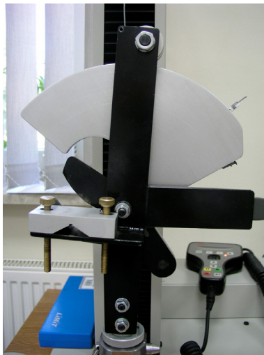
Rys. 2. Maszyna wytrzymałościowa Insight 2 firmy MTS wyposażona w przystawkę tnącą materiałów biologicznych
