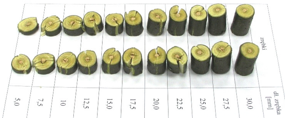
Rys. 5. Pęknięcia zrębków w zależności od ich długości cięcia (w = 44%) Fig. 5. Chip cracks depending on their cutting length (w = 44%)
