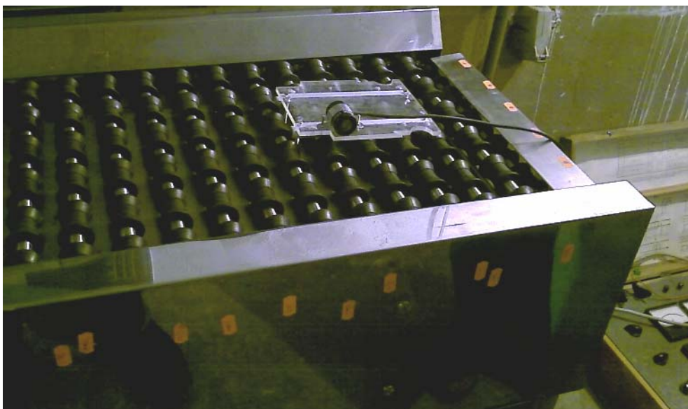
Rys. 2. Uchwyt z sondą pomiarową na torze w badanym urządzeniu.
