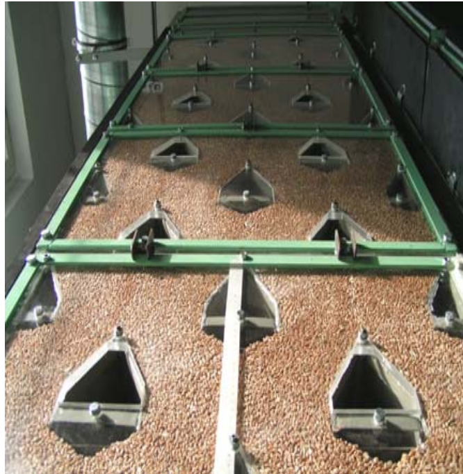
Rys. 1. Układ doświadczalnej suszarni ATB ze ścianką z przezroczystego pleksiglasu Fig. 1. Layout of ATB test dryer with Plexiglas® wall
