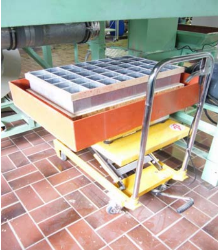
Rys. 5. Zestaw do pomiaru rozkładu przepływu masy ziarna przy wysypie z suszarni pilotowej Fig. 5. Set-up for measuring the mass flow distribution at discharge by the pilot dryer
