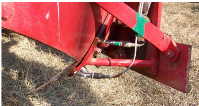
Rys. 3. Odkładnica wyposażona w sprężyny talerzowe Fig. 3. Moldboard equipped with disc springs
