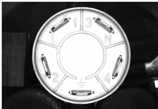
Rys. 4. Przykład zorientowanego kątowno wyrobu (ujęcie z kamery)
