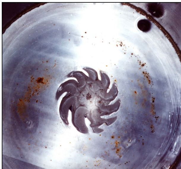
Rys. 3. Stożek osadu w postaci „spiralnej rozety” [Kowalczyk, Diakun 2000] Fig. 3. Deposit cone in form of “spiral rosette” [Kowalczyk, Diakun 2000]
