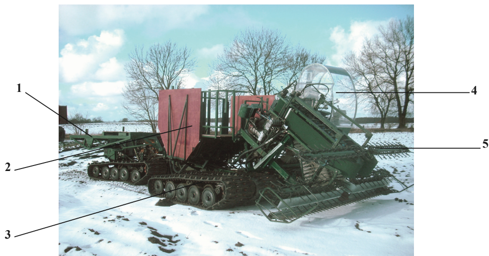
Rys. 2. Maszyna do zbioru jednofazowego trzciny zwyczajnej. 1 – platforma załadowcza (półnaczepa); 2 – balotownica wraz z układem transportującym; 3 – układ jezdny o zmniejszonych naciskach wraz z układem przeniesienia napędu; 4 – kabina kierowcy; 5 – przyrząd żniwny
