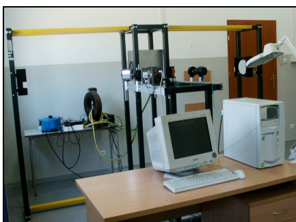
Rys. 2. Widok ogólny stanowiska pomiarowego z wykorzystaniem smugoskoku oraz ustawienie spirali z prętem
