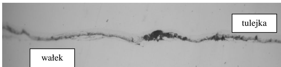
Rys. 2. Obraz powierzchni styku wałka z podpiaściem azotowanym i tulejki, pow. 400 \times , próbka nietrawiona
