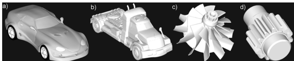
Rys. 1. Modele CAD przeznaczone do wykonania prototypów fizycznych: a) model koncepcyjny samochodu sportowego, b) model koncepcyjny ciężarówki, c) model wirnika turbosprężarki, d) model koła zębatego
