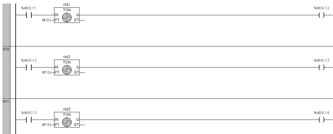
Rys. 3. Timery przełączające poszczególne fazy doju (Źródło: opracowanie własne) Fig. 3. The timers switching over particular milking phases
