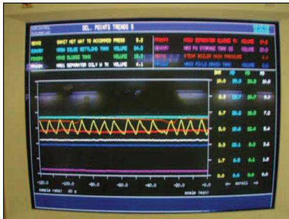
Rys. 2. Przykładowy fragment przebiegu zmian ciśnienia pary w kotle na monitorze centrali kontrolno – manewrowej siłowni statku w funkcji czasu pracy (linia żółta)
