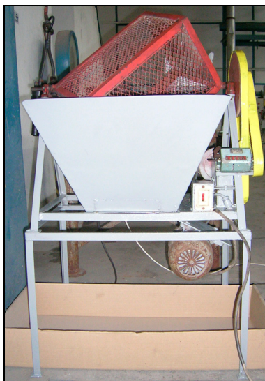
Rys. 1. Widok stanowiska do badania trwałości brykietów Fig. 1. View of test stand for briquette durability evaluation
