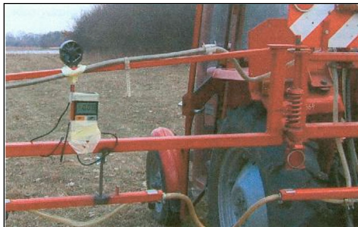
Rys. 3. Pomiar prędkości wiatru Fig. 3. Wind velocity measurement
