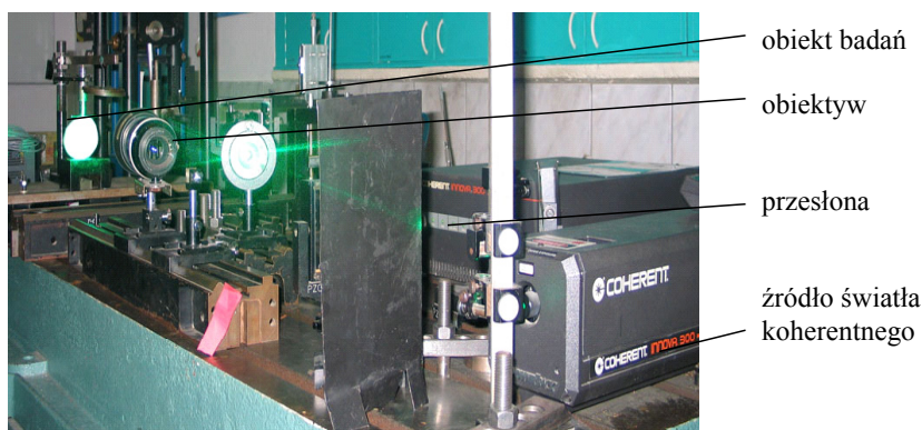
Rys. 1. Stanowisko pomiarowe do badań metodą fotografii plamkowej
