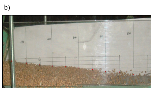
Rys. 2. Widok zamocowanego modelu jednoosekcyjnego separatora żaluzjowego (a) oraz rzeczywisty obraz rozkładu masy ziarna na powierzchni sita (b) masy zbożowej na powierzchni separatora (rys. 2b)
