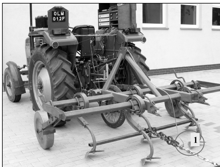
Rys. 4. Widok agregatu ciągnikowego obciążonego siłą zewnętrzną: 1 – czujniki siły U9B Fig. 4. View of a tractor aggregate with the external force load: 1 – force sensors U9B
