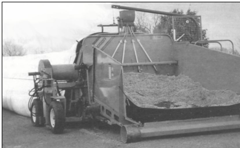
Rys. 3. Napełnianie rękawa foliowego wysłódkami z dozowaniem preparatu konserwującego Fig. 3. Filling a foil sleeve with beet pulp and feeding a preservative
