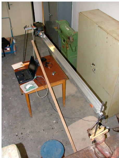
Rys. 4. Widok laserowego profilomierza w laboratorium pomiarowym Fig. 4. View of laser profile measurement gauge in a measurements laboratory
