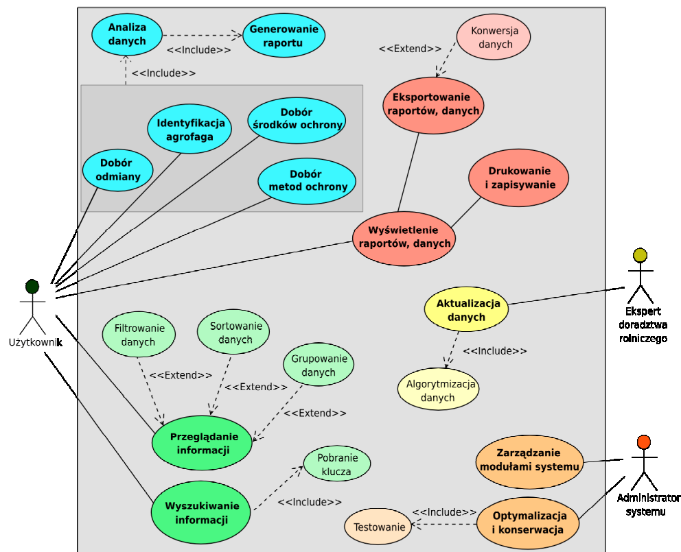
Rys. 1. Diagram przypadków użycia przedstawiający stronę funkcjonalną aplikacji Fig.1. Use case diagram showing the functional aspects of the system
