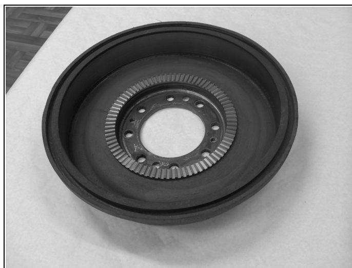
Rys. 2. Tarcza impulsowa tylnego koła Fig. 2. Rear wheel impulse disk
