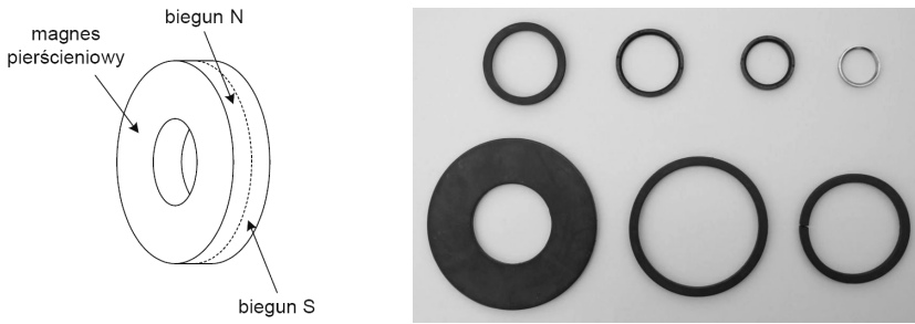
Rys. 2. Kształt i biegunowość magnesów umieszczanych w silownikach
