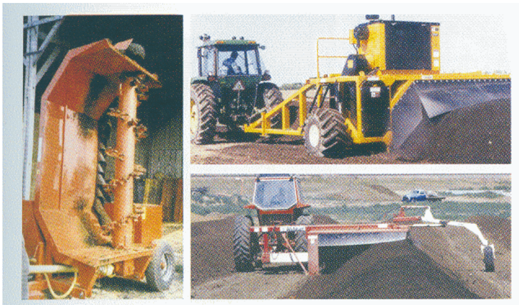
Rys. 8. Maszyna do odwracania i formowania pryzm sprzężona z ciągnikiem. Fotografia z lewej strony – położenie transportowe maszyny firmy Sandberger. Fotografia górna – maszyna firmy Wildcat Manufacturing, fotografia dolna – maszyna z Washington State University
